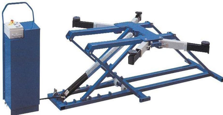
Рисунок 2.11 Внешний вид подъемника
