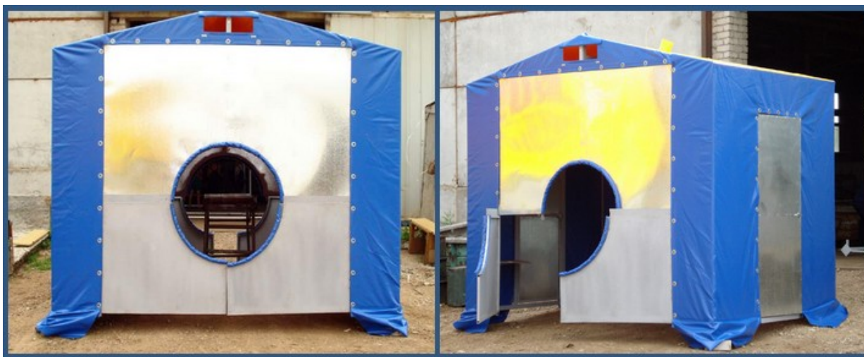
Рисунок 2 – Общий вид быстроразборной-сборной палатки сварщика для сварки трубопроводов
