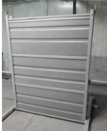
Рисунок 5 – Звукопоглощающий экран в цехе
