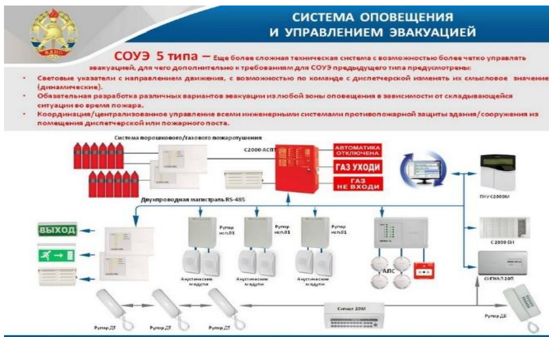
Рисунок 3 – Система оповещения и управлением эвакуацией
