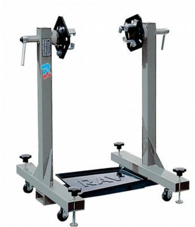
Рисунок 2.4 - Кантователь двигателя двухстоечный мобильный, г/п 799 кг Ravfaglioli R12
