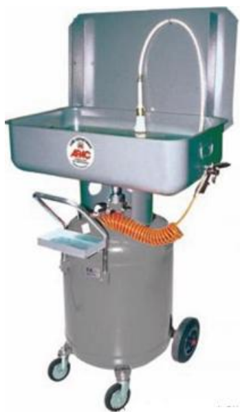
Рисунок 12 - Пример ручной мойки с переливанием моющей жидкости из бака давлением воздуха
