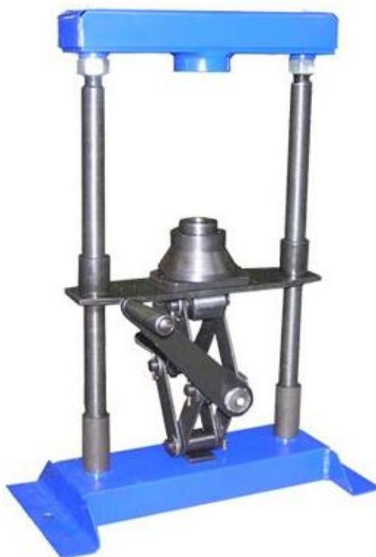
Рисунок 3.4 -Стенд разборки и сборки энергоаккумулятора тормозной камеры
