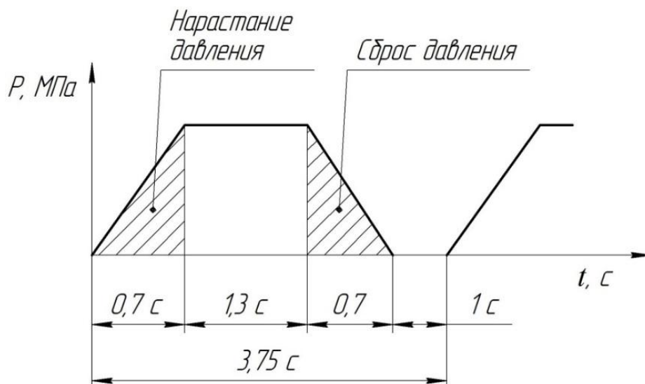
Рисунок 2.30 – Диаграмма нарастания и сброса давления
