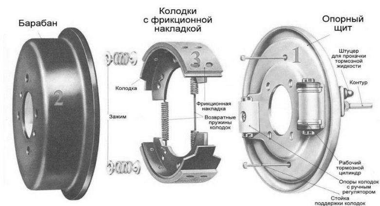
Рисунок 3.1 – Устройство тормозного механизма
