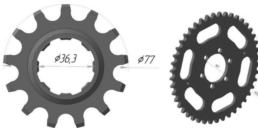
Рисунок 2.13 – Звездочка (ведомая) 14 диаметром 77 мм и звездочка (ведущая) 44 диаметром 230 мм
