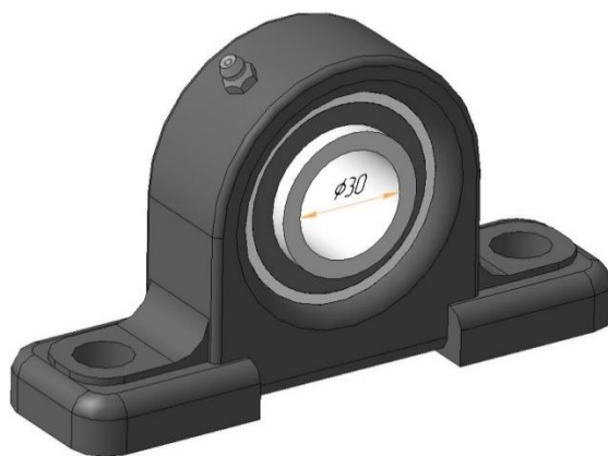
Рисунок 2.6 – Подшипниковый узел серии UCP под диаметр 30 мм
