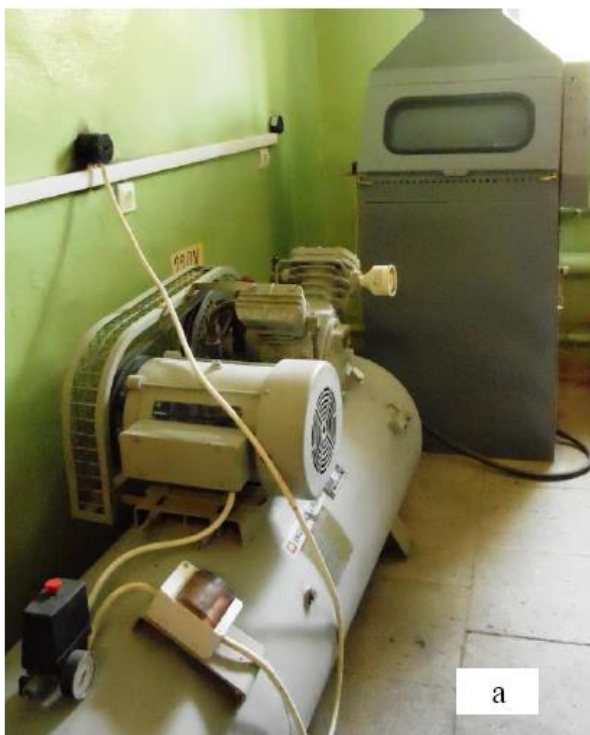
Рисунок 12 – Оборудование для пескоструйной обработки: а – компрессор и пескоструйная камера; б – обрабатываемые ролики и сопло пескоструйного аппарата
