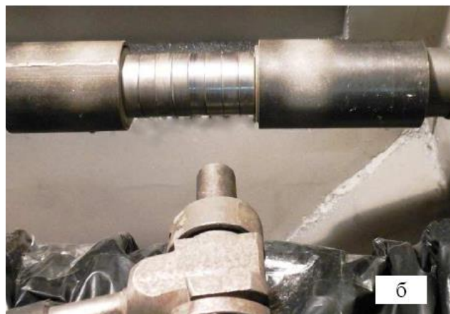
Рисунок 12 – Оборудование для пескоструйной обработки: а – компрессор и пескоструйная камера; б – обрабатываемые ролики и сопло пескоструйного аппарата
