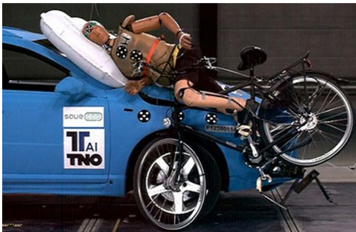
Рисунок 1 – Пример установки внешней подушки безопасности
