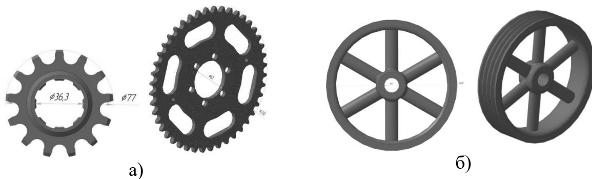
Рисунок 12 – Варианты передач, цепная (а), ременная (б)
