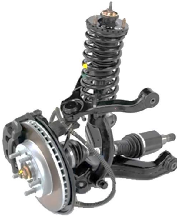
Рисунок 8 – Двухрычажная независимая подвеска
