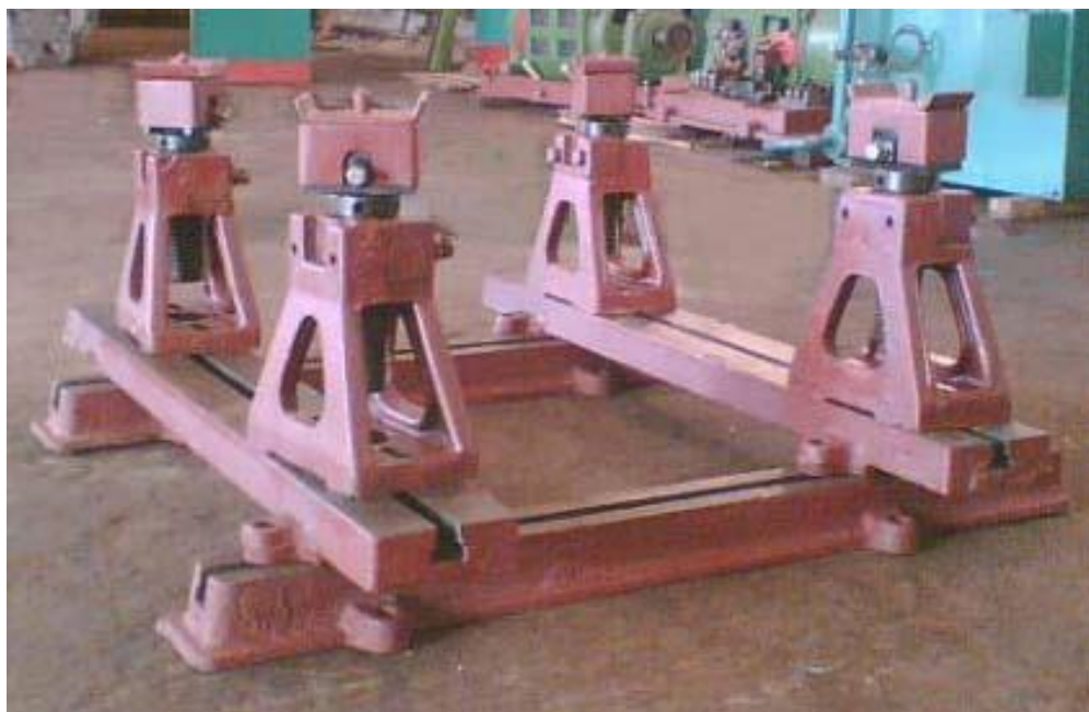
Рисунок 5 – Отдельное расположение стоек и направляющих платформ
