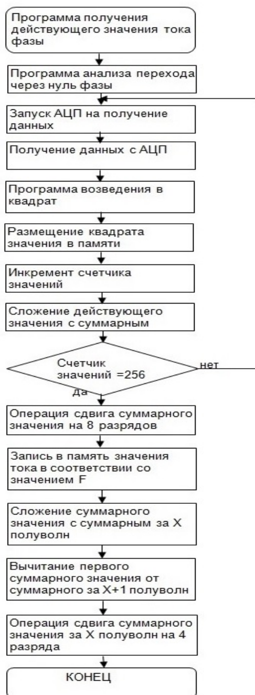
Рисунок 2.11- Алгоритм получения действующего значения тока фазы
