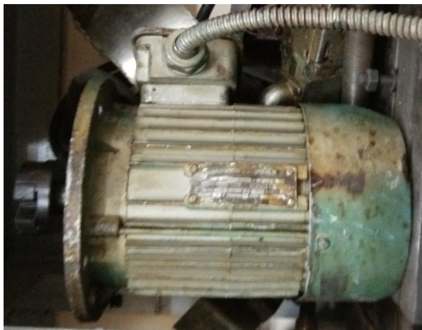
Рисунок 3 – Состояние электродвигателя ножа гранулятора
