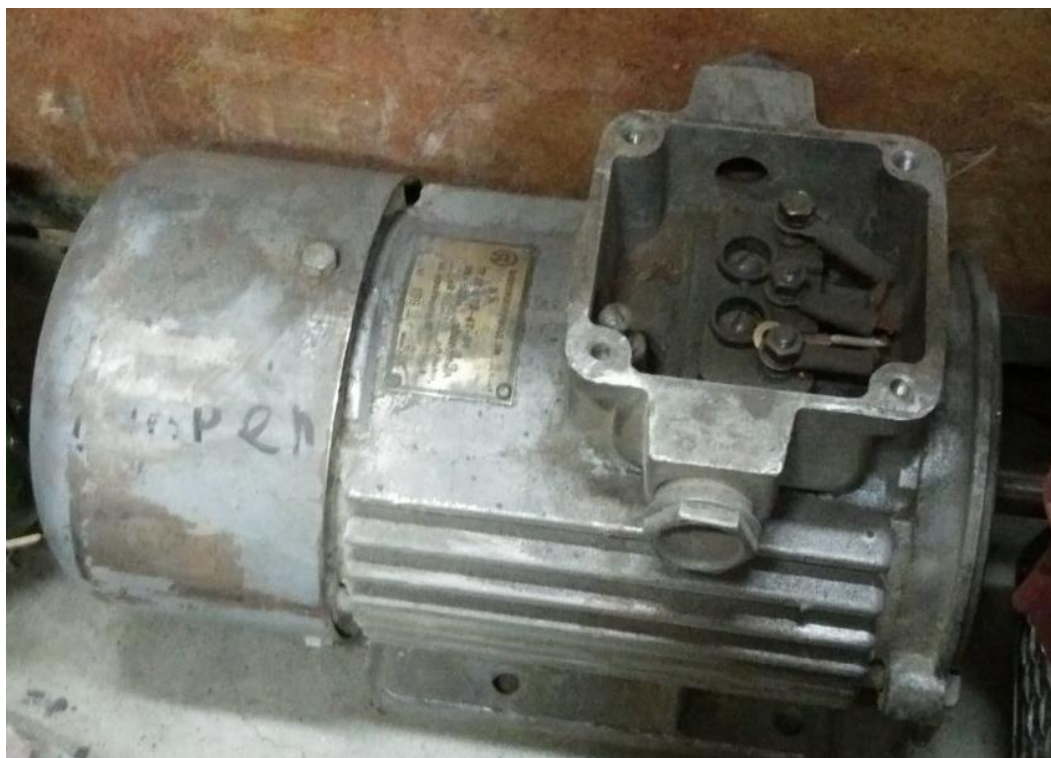
Рисунок 2 – Состояние электродвигателя ВС-4
