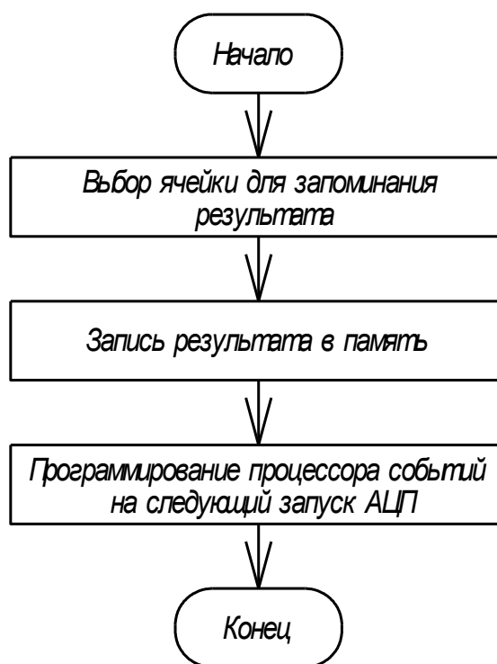
Рисунок 5.4 - Структурная схема алгоритма работы подпрограммы обработки события «Конец преобразования»
