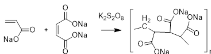
Рисунок 19 - Схема получения сополимера акрилата и малеата натрия
