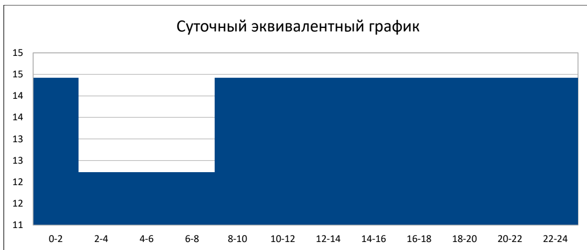
Рисунок 5 - Эквивалентный график нагрузки трансформаторов
