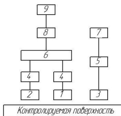
1 – устройство с антеннами; 2 – приемные вибраторы; 3 – управляющее устройство; 4 – усилитель; 5 – устройство генерирования СВЧ энергии; 6 – согласующее устройства времени, шага измерений; 7 – устройство возбуждения электромагнитных волн; 8 – устройство ввода, вывода параметров, внутреннего диагностирования; 9 – ПЭВМ с программным обеспечением
