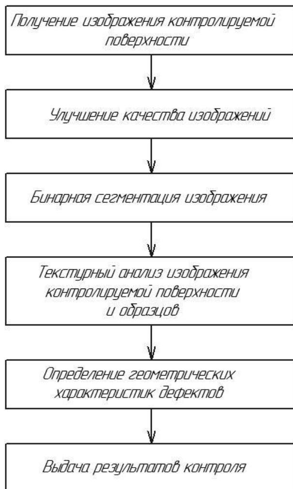
Рисунок 39 – Алгоритм цифровой обработки изображения применительно к контролю дефектов лакокрасочного покрытия
