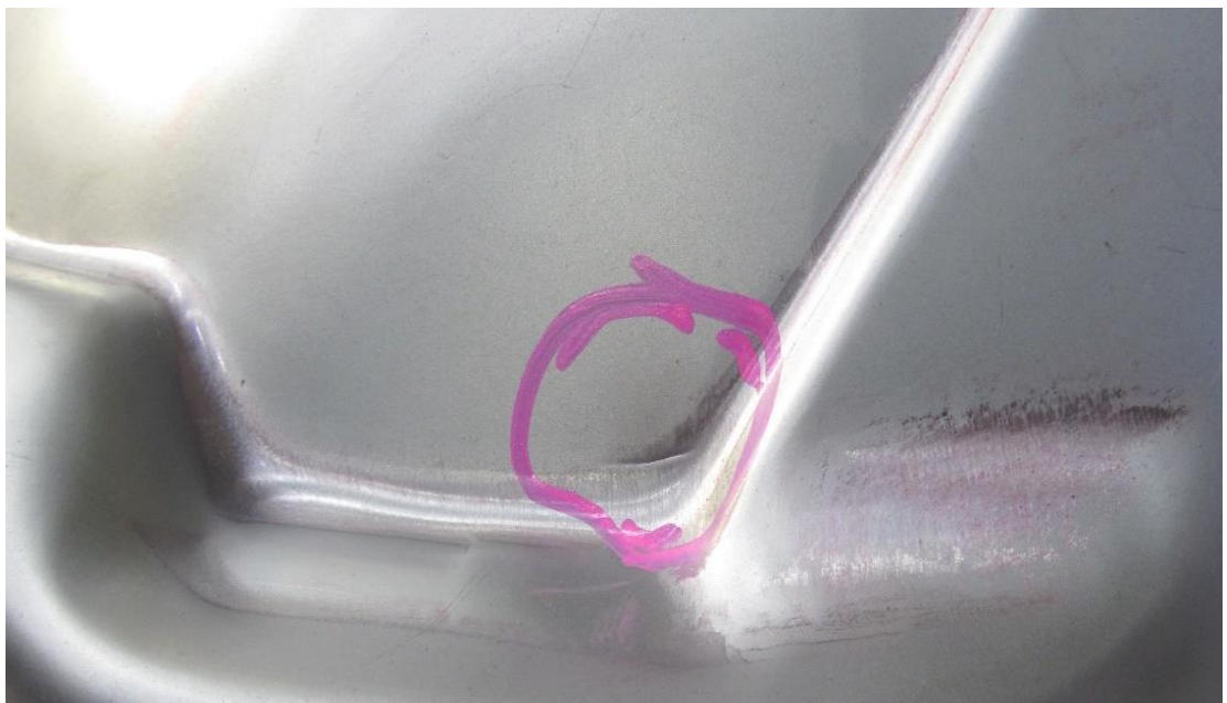
Рисунок 11 – Утонение металла при вытяжке на производстве
