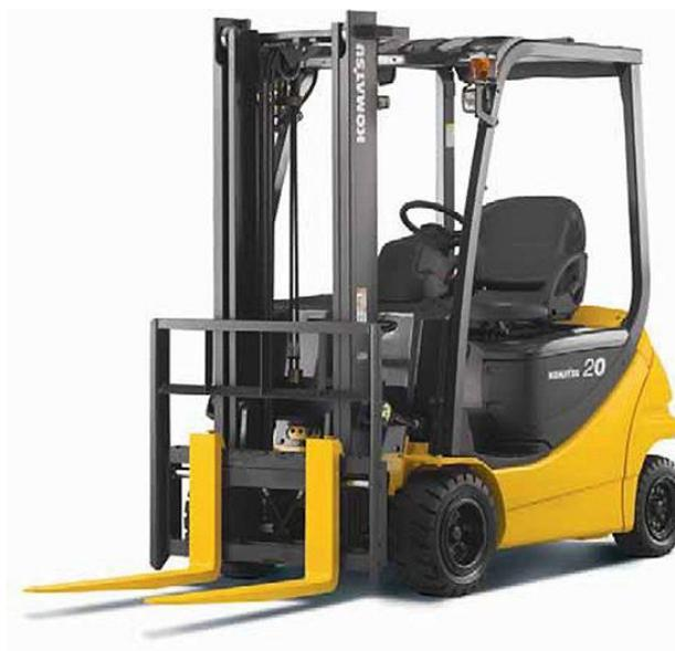
Рисунок 4 – Электропогрузчик Komatsu FB15M-12
