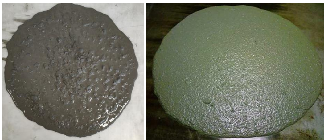
Рисунок 20 – Расплыв на конусе Хегерманна и конусе Абрамса
