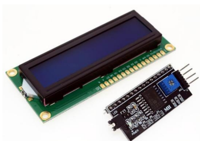
Рисунок 16 – LCD дисплей 1602 с шиной I2C
