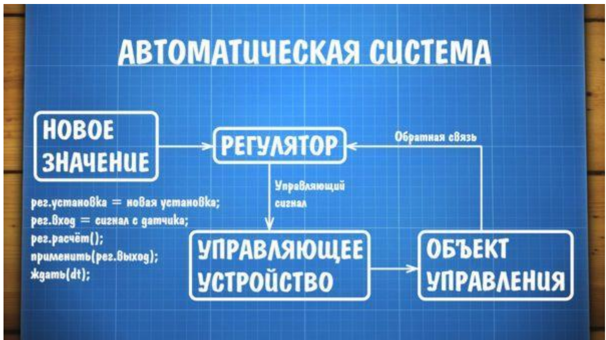
Рисунок 17 – Схема работы ПИД регулятора
