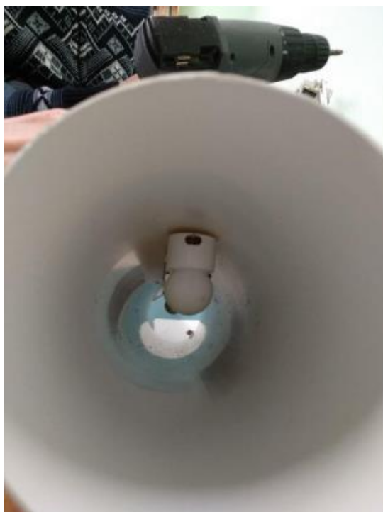
Рисунок 11 – Установка ультрафиолетовой лампы в трубу
