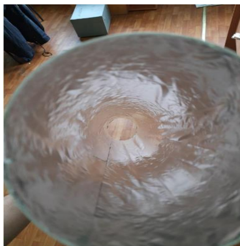
Рисунок 10 – Фольга, вклеенная в ПВХ трубу
