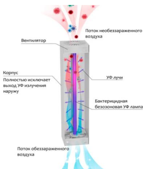
Рисунок 1 – Принцип работы рециркулятора
