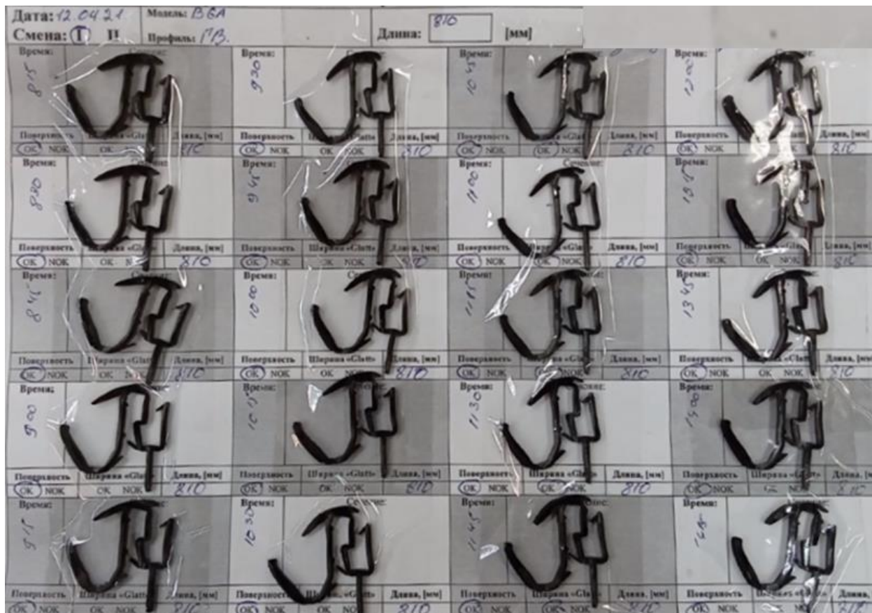
Рисунок 36 – Срезы профиля уплотнителя для определения стабильности поперечных размеров
