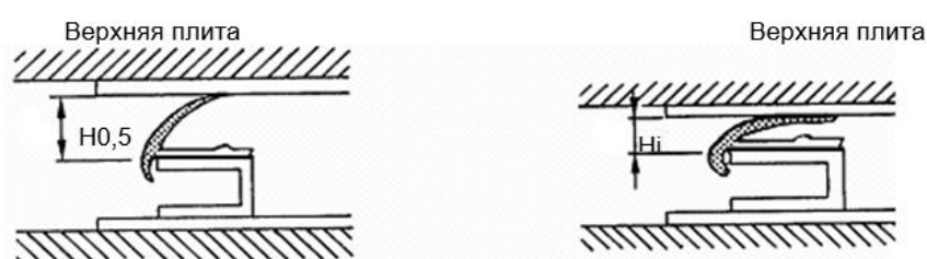
Рисунок 10 – Схема сжатия образцов «плоских» уплотнителей
