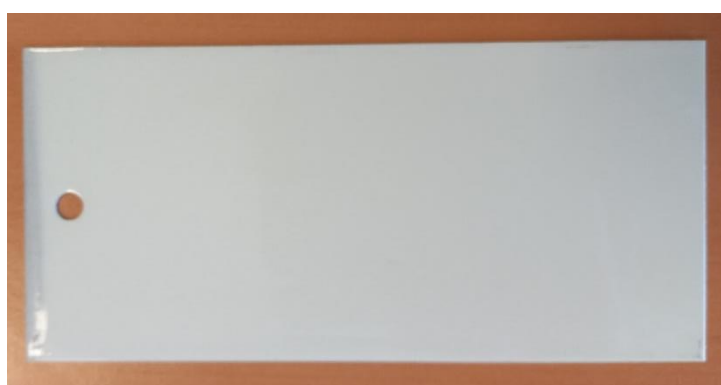
Рисунок 27 – Пластина со светлой эмалью после испытаний термоэластопласта этиленпропиленового
