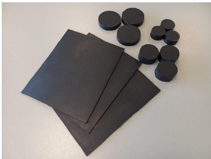
Рисунок 3 – Образцы эластомеров для испытаний в виде вулканизированных пластин и цилиндров
