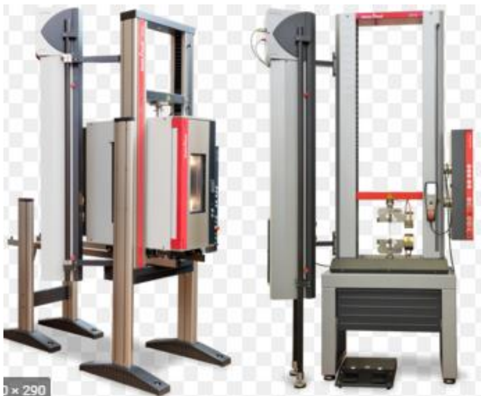
Рисунок 13 – Разрывная машина «Zwick Rowel Z010» с встроенной термокамерой
