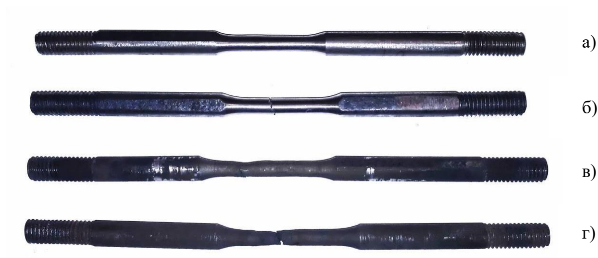
Рисунок 5 – Внешний вид образцов на растяжение: до испытания – а; после испытания при: 22 °С – б; при 930 °С – в; 1000 °С – г
