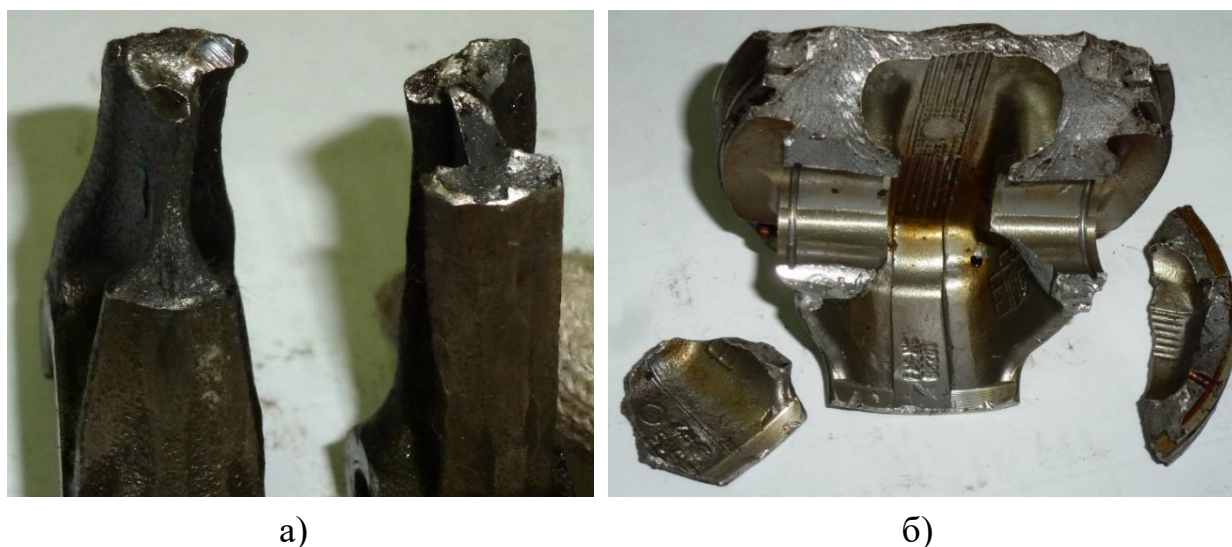
Рисунок 29 – Изломы стального шатуна (а); изломы поршня из алюминиевого сплава (б)
