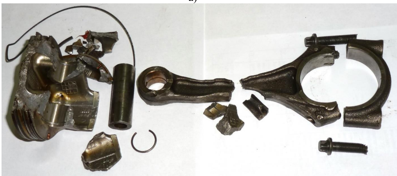
Рисунок 28 – Внешний вид разрушенной шатунно-поршневой группы
