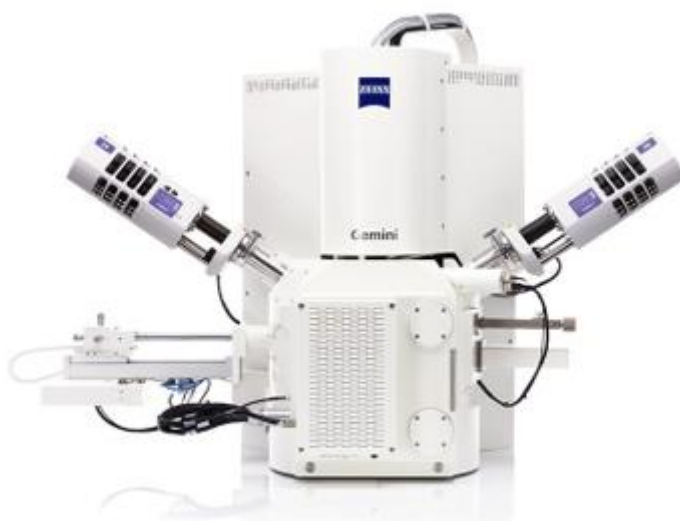
Рисунок 21 - Растровый электронный микроскоп Zeiss Sigma
