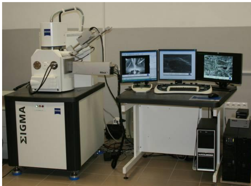
Рисунок 14 – Оборудование для исследования поверхности: сканирующий электронный микроскоп Carl Zeiss Sigma
