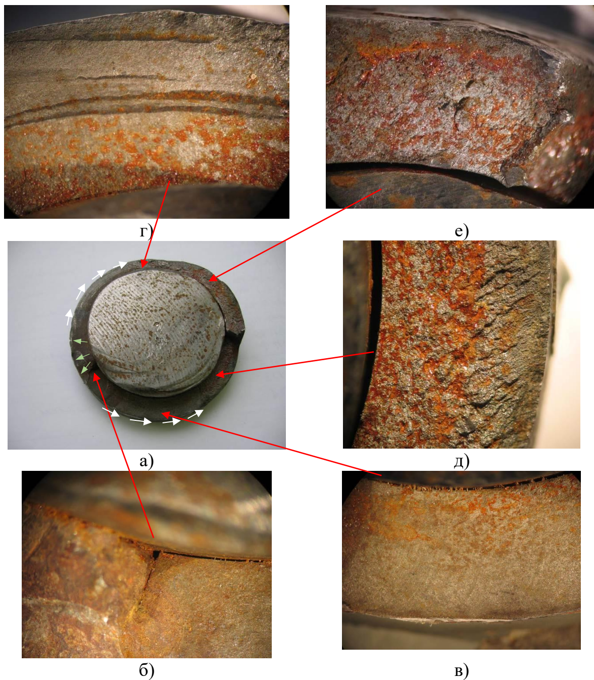
Рисунок 25 – Схема развития разрушения трубы маятниковой опоры: а – общий вид излома; стрелки салатового цвета – первоначальное движение трещины; белые стрелки – направление развития усталостного разрушения; б – трещина в очаге разрушения; в и г – усталостные дорожки; д и е – окончательный долом сечения
