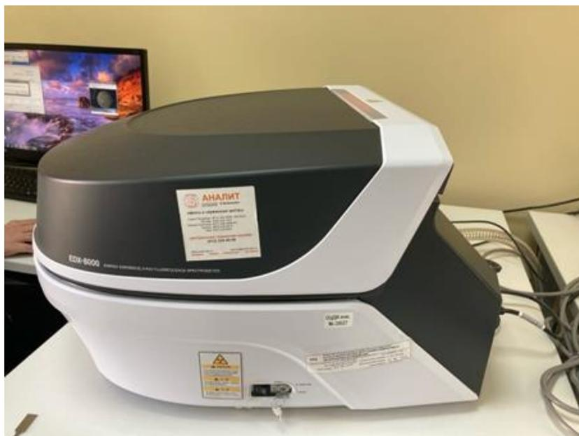
Рисунок 23 - Энергодисперсионный рентгенофлуоресцентный спектрометр EDX-8000
