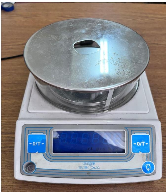
Рисунок 18 – Измерение массы образцов после высокотемпературной выдержки при испытании жаростойкости
