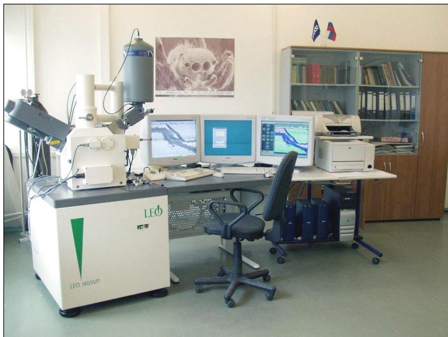
Рисунок 14 – Внешний вид комплекса LEO 1455 VP
