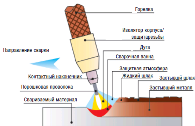
Рисунок 20 – Схема выполнения сварки самозащитной порошковой проволокой
