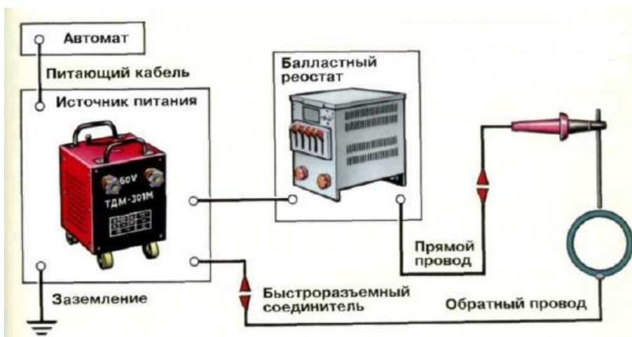
Рисунок 18 – Схема выполнения ручной дуговой сварки штучными электродами
