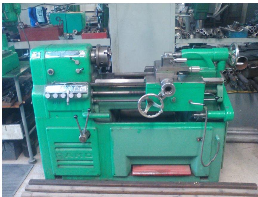
Рисунок 15 – Токарный станок РАМО модель Т37
