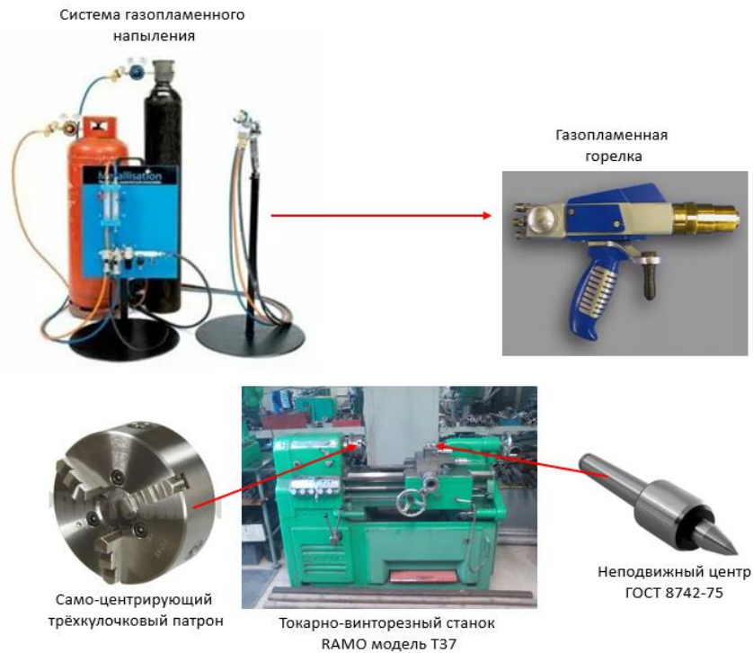
Рисунок 22 – Оборудование и средства оснащения газопламенного напыления
