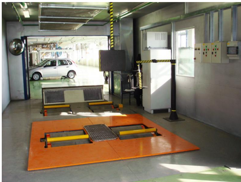
Рисунок 1 – Общий вид стенда определения тяговых качеств автомобиля
