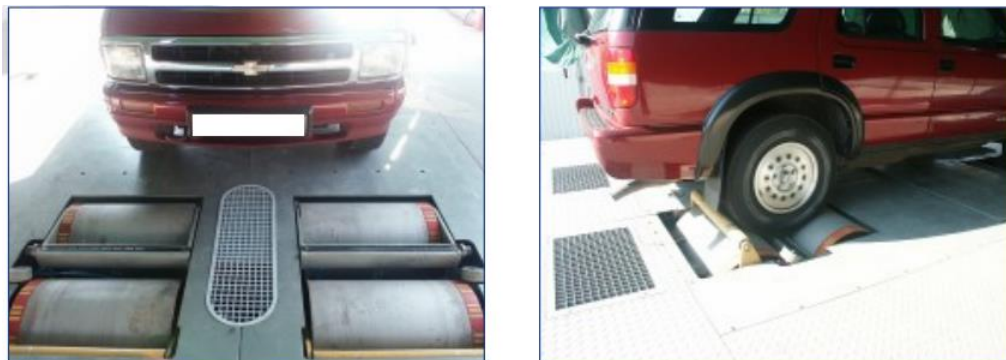
Рисунок 2 – Стенд для определения тяговых качеств СДМ 1-3500.200
