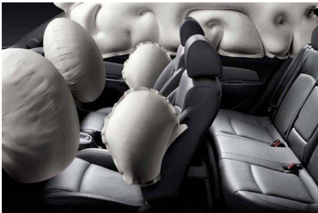
Рисунок 35 - Пример боковой подушки безопасности для защиты от травм груди
