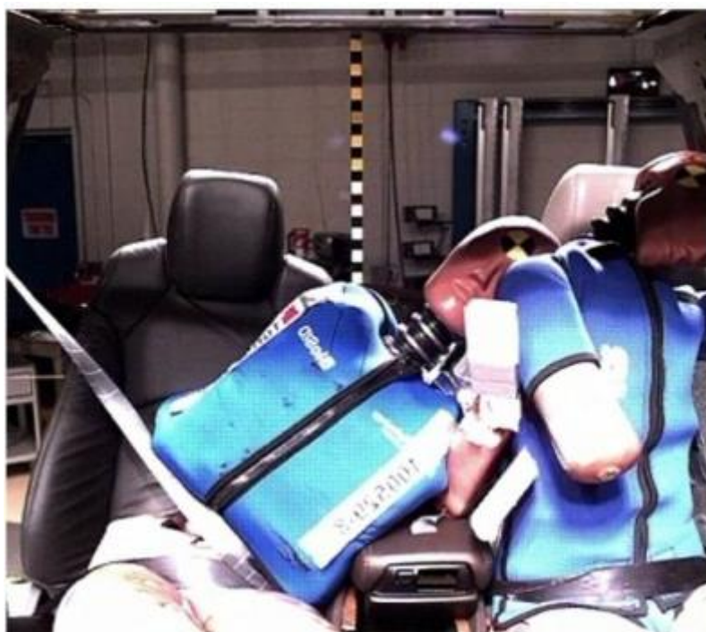
Рисунок 38 – Имитация бокового удара для проверки раскрытия боковой подушки безопасности
