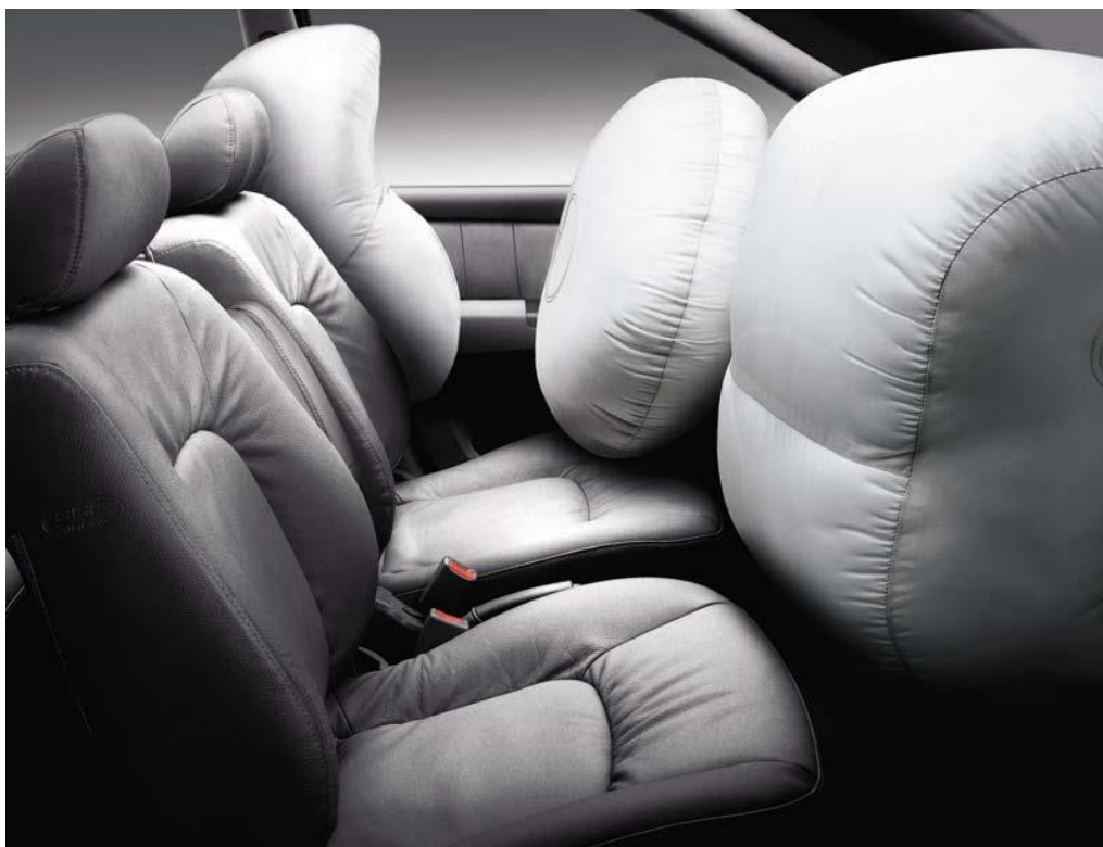
Рисунок 34 - Пример боковой подушки типа голова/грудь
