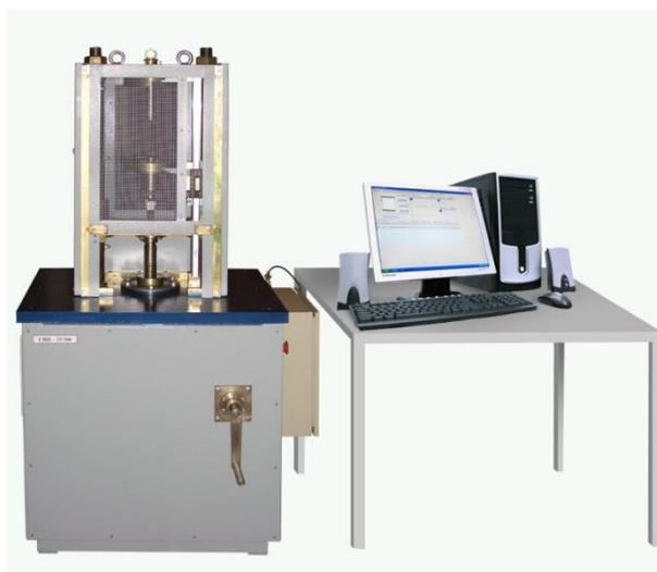
Рисунок 33 –Стенд для испытаний и тарирования пружин подвесок автомобилей категории М<sub>1</sub> СИП - 25/300У
