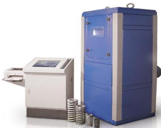
Рисунок 32 - Стенд для испытаний и тарирования пружин подвески автомобилей категории М<sub>1</sub> ПКТБА-СИ-25М
