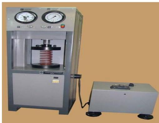
Рисунок 31 - Стенд для тарирования пружин СТП-1
