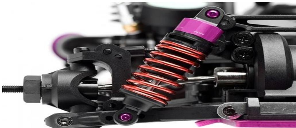
Рисунок 14 – Передняя подвеска автомобиля с установленным амортизатором с пружиной с возможностью регулирования её жёсткости
