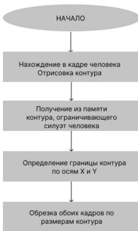
Рисунок 37 – Блок-схема алгоритма ограничения поиска движения по силуэту человека
