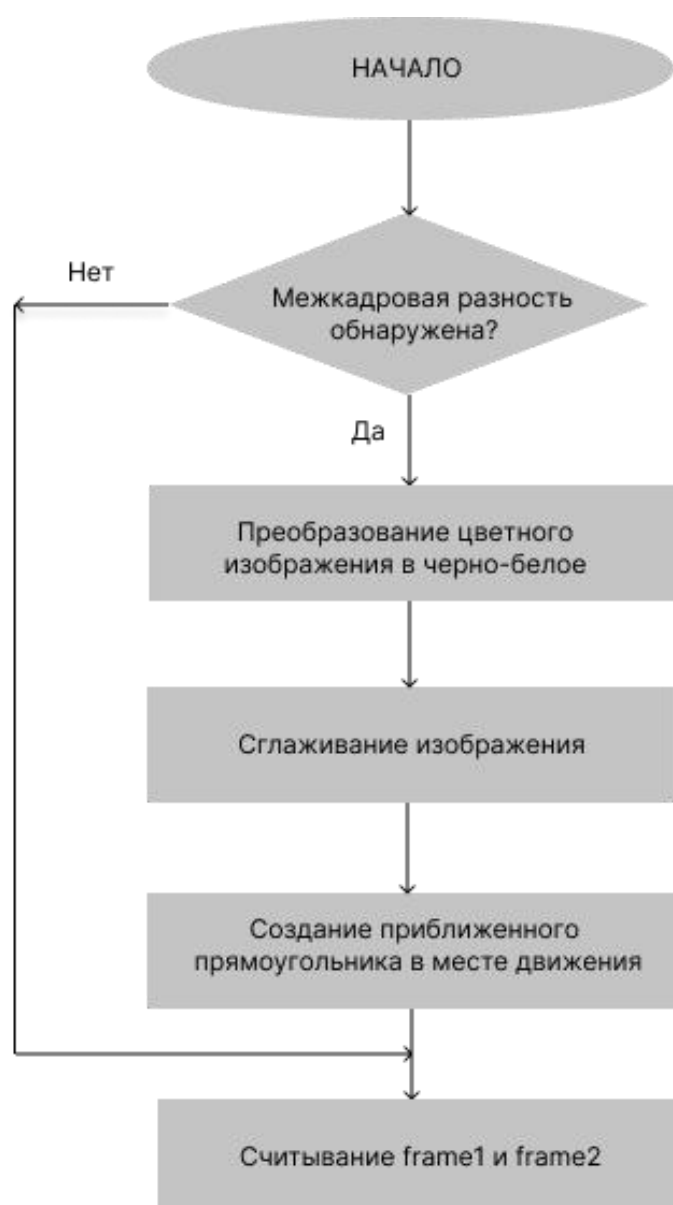
Рисунок 28 – Блок-схема алгоритма детектирования движения в кадре
