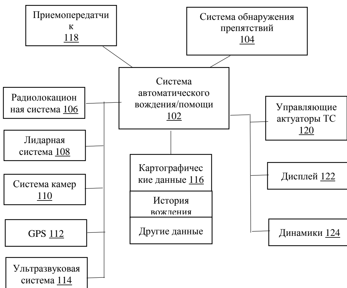
Рисунок 3 – Блок-схема управления ТС при помощи системы обнаружения препятствий
