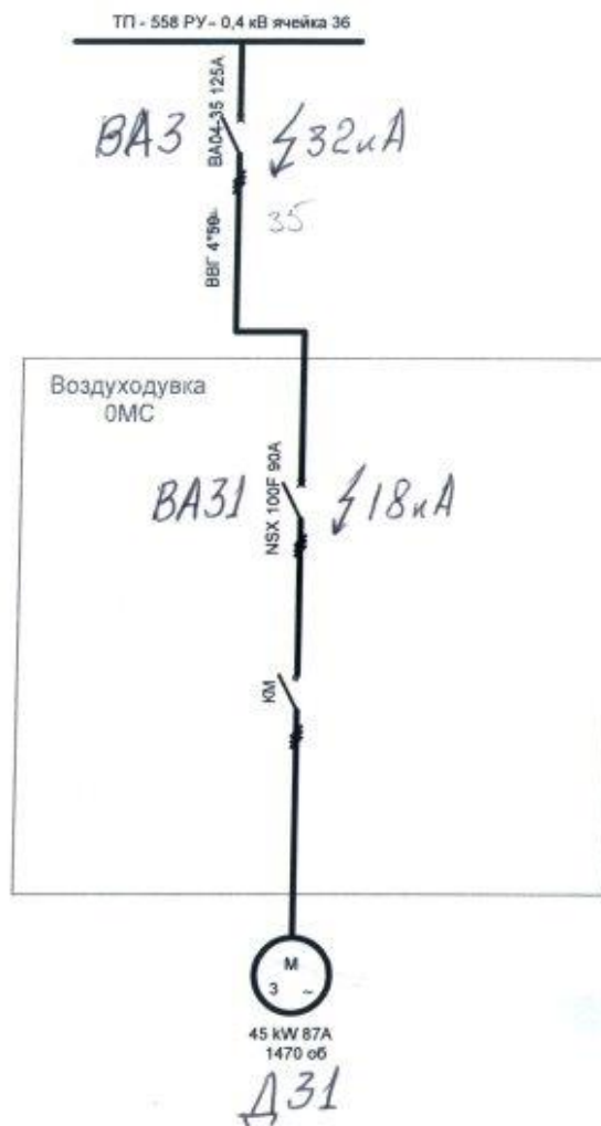
Рисунок Б.10 - Однолинейная схема щита Воздуходувка ОМС
