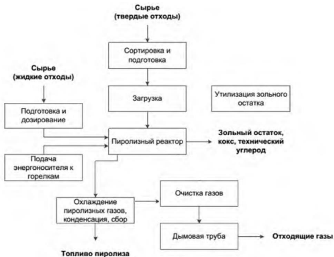
Рисунок 6 — Общая схема пиролиза отходов
