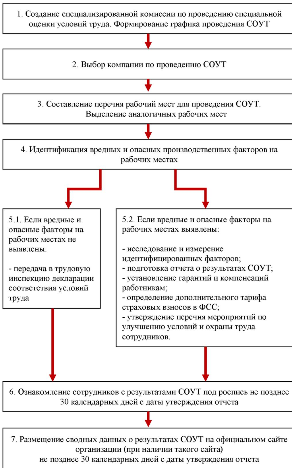
Рисунок Б.1 - Схема проведения СОУТ
