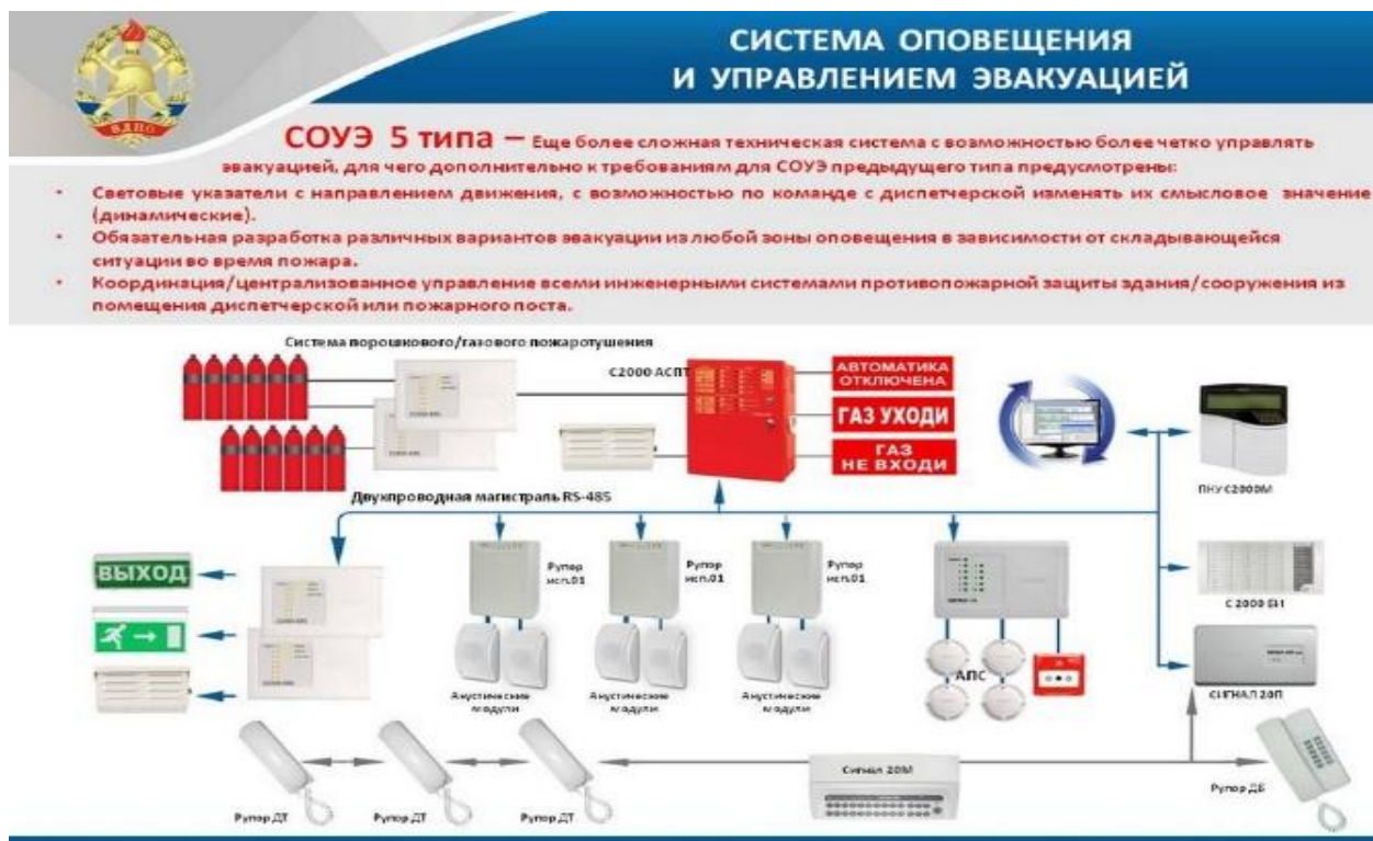
Рисунок 5 – Система оповещения и управлением эвакуацией
