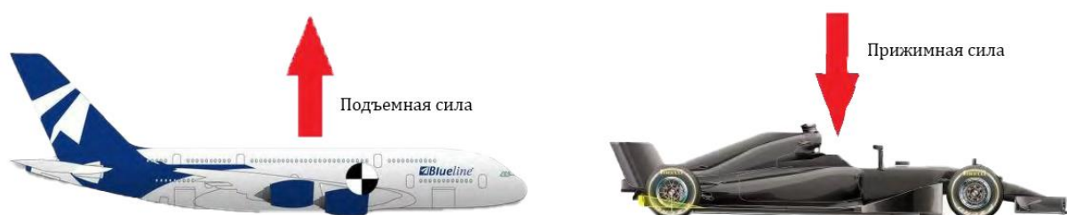
Рисунок 1 – Направление прижимной и подъемной сил
