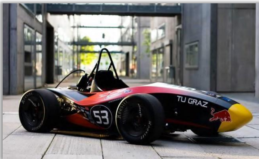
Рисунок 8 – Один из лучших аэродинамических элементов – носовой обтекатель, болид Tankia 2010 – TU Graz
