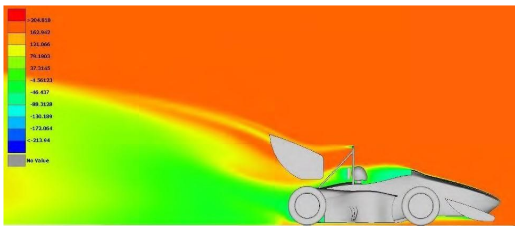
Рисунок 42 – Контур распределения давления модели с полным аэродинамическим обвесом
