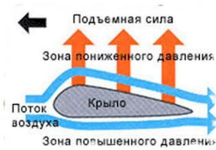
Рисунок 5 – Наглядная работа воздушных потоков
