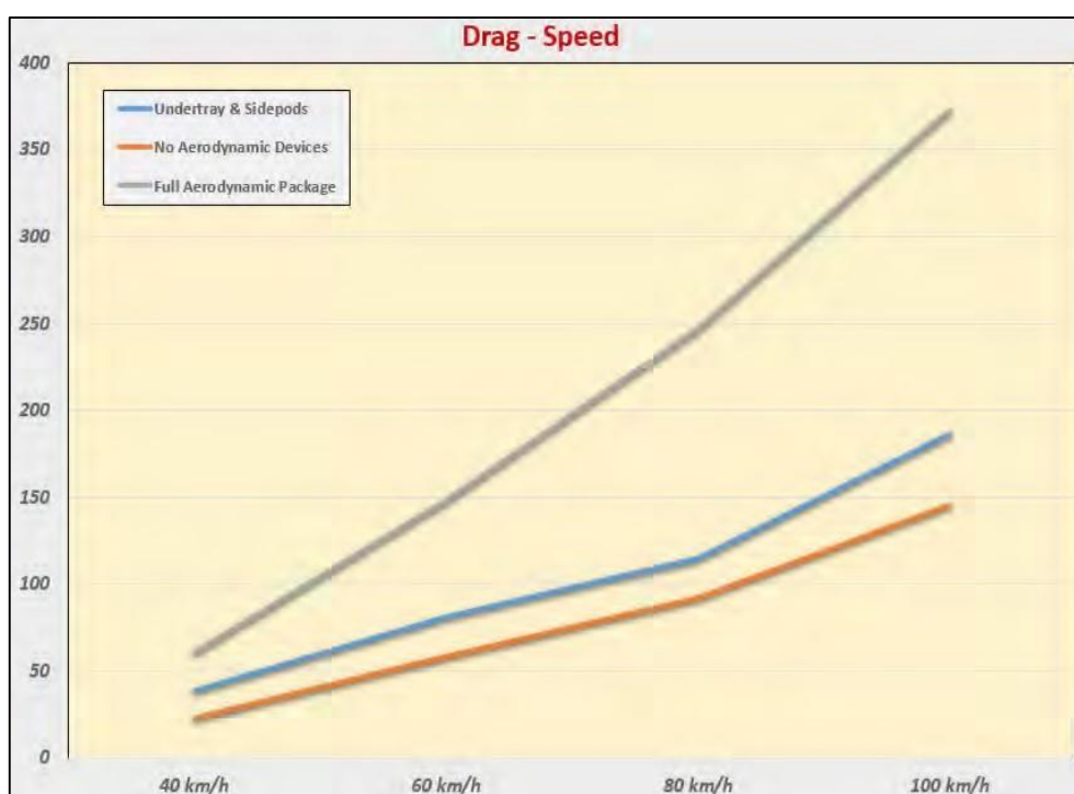
Рисунок 52 – График возникновения лобового сопротивления в каждом случае для скоростей от 40 до 100 км/ч
