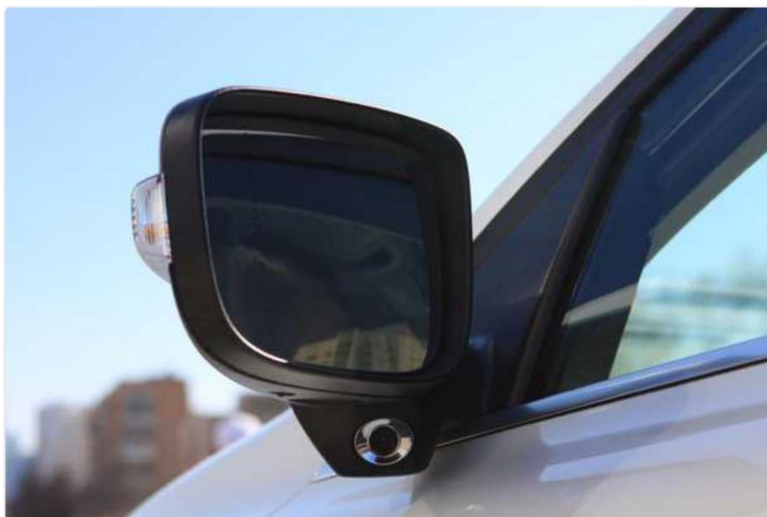
Рисунок 17 – Зеркало заднего вида с сенсором слепой зоны в виде камеры
