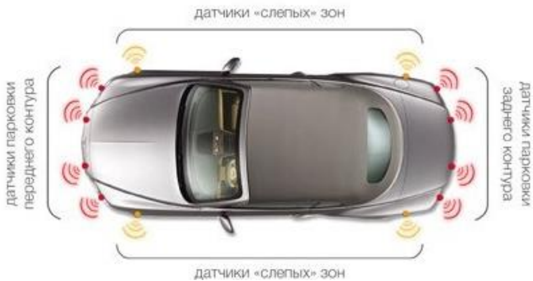
Рисунок 16 – Расположение сенсоров в виде радаров на автомобиле
