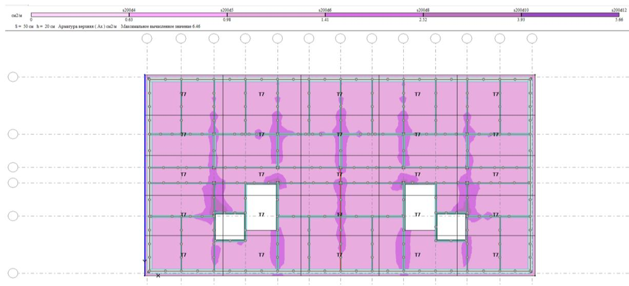
Рисунок 11 – Законтуривание (определение) максимальных значения  $A_x$  и  $A_y$  нижней арматуры
