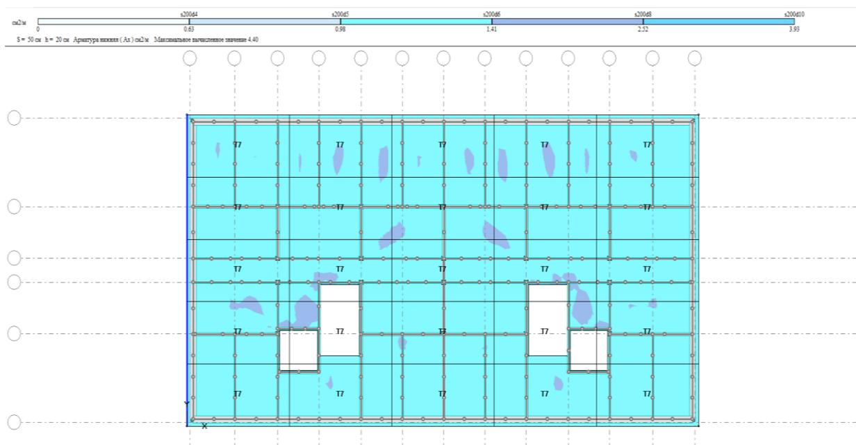
Рисунок 14 – Изополя нижнего армирования плиты перекрытия по Оси X
