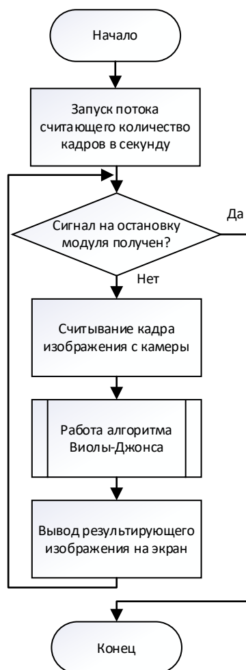
Рисунок 28 – Блок-схема обобщённого варианта алгоритма Виолы-Джонса однопоточной реализации
