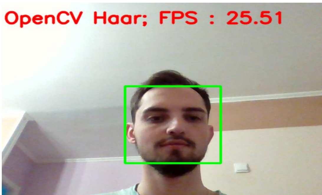
Рисунок 39 – Тестирование алгоритма Виолы-Джонса без использования подхода «multiprocessing»
