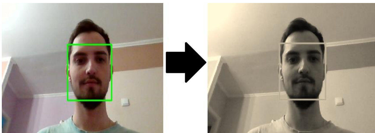
Рисунок 27 – Преобразование в градиент серого
