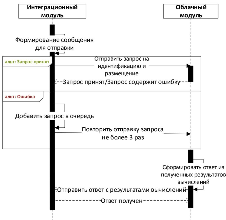
Рисунок 13 – Диаграмма последовательности интеграционного и облачного модулей в рамках бизнес-процессов приёма и размещения товаров
