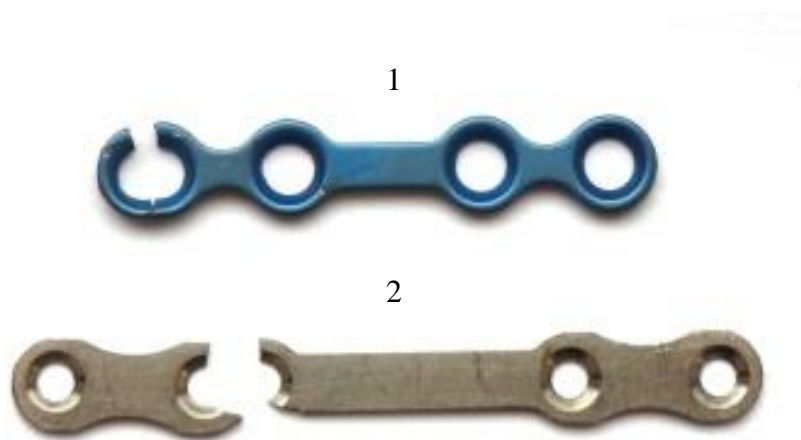
Рисунок 15 – Пластины фирмы ООО «Conmet» (1) и пластины из КЗ и УМЗ титана (2) после усталостных испытаний
