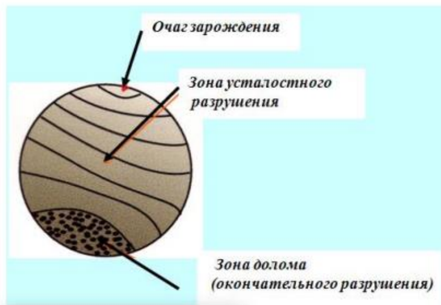
Рисунок 5 – Вид усталостного излома
