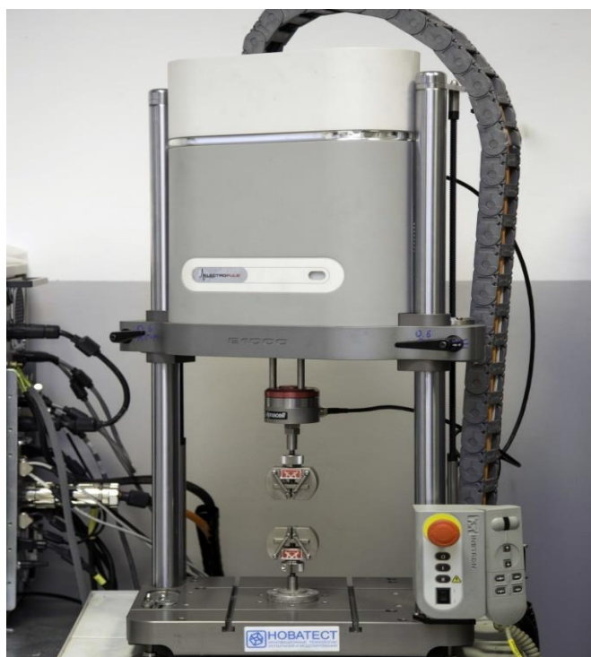
Рисунок 12 –Динамическая испытательная машина Instron ElectroPuls E1000
