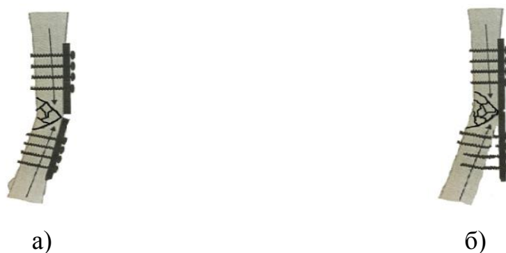
Рисунок 2 – Схема перелома пластины в месте наибольшей концентрации напряжений (а) и схема разрушения винтов или мест их крепления в кости
