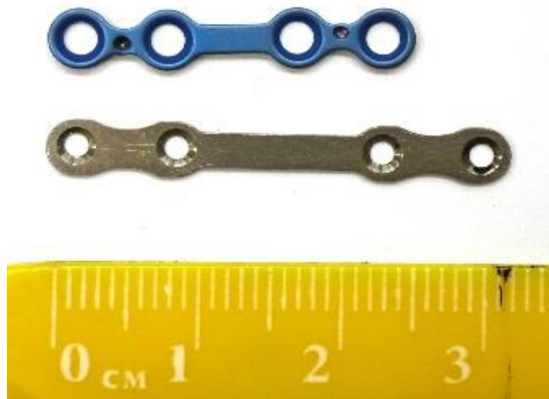
Рисунок 14 – Пластины фирмы ООО «Conmet» (вверху) и пластины из КЗ и УМЗ титана (внизу) до испытания
