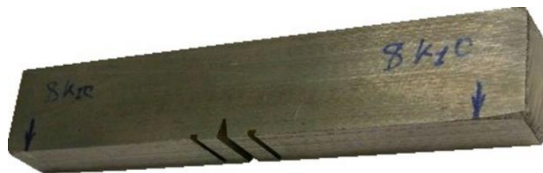
Рисунок 20 – Образец для испытаний стали на усталость
