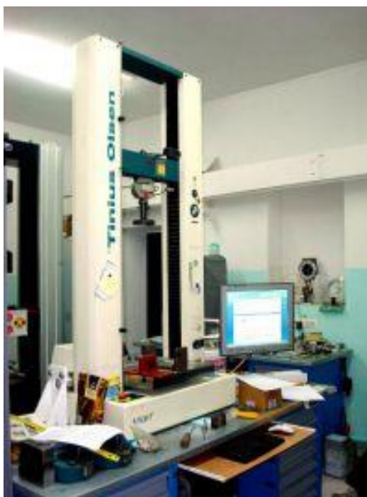
Рисунок 19 - Универсальная испытательная машина Н50КТ, с компьютерным управлением предназначена для определения механических свойств материалов
