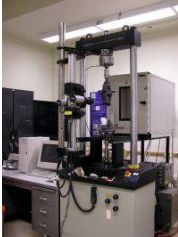
Рисунок 22 – Испытательная установка Instron 8801
