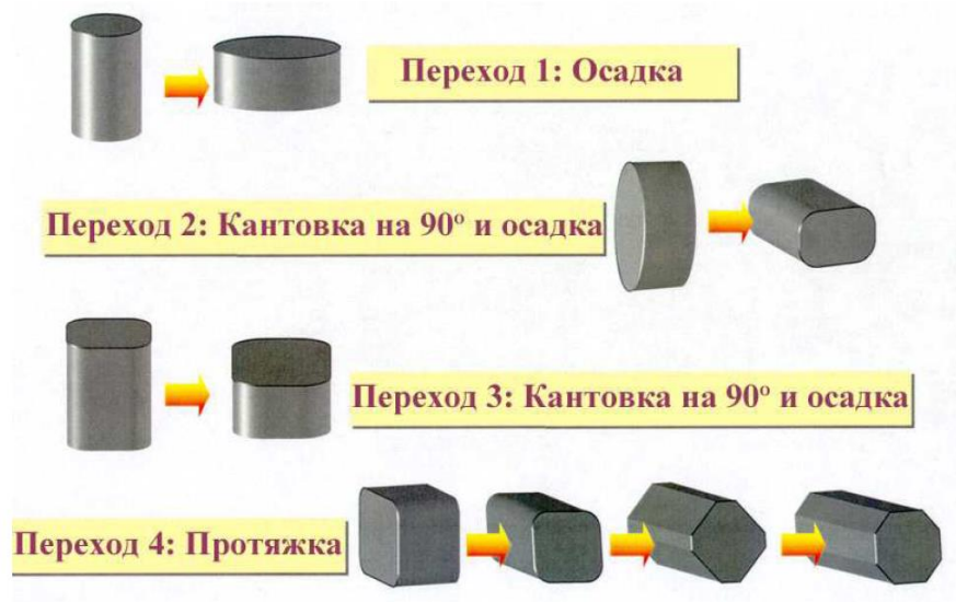
Рисунок 14 – Последовательность операций всестороннейковки
