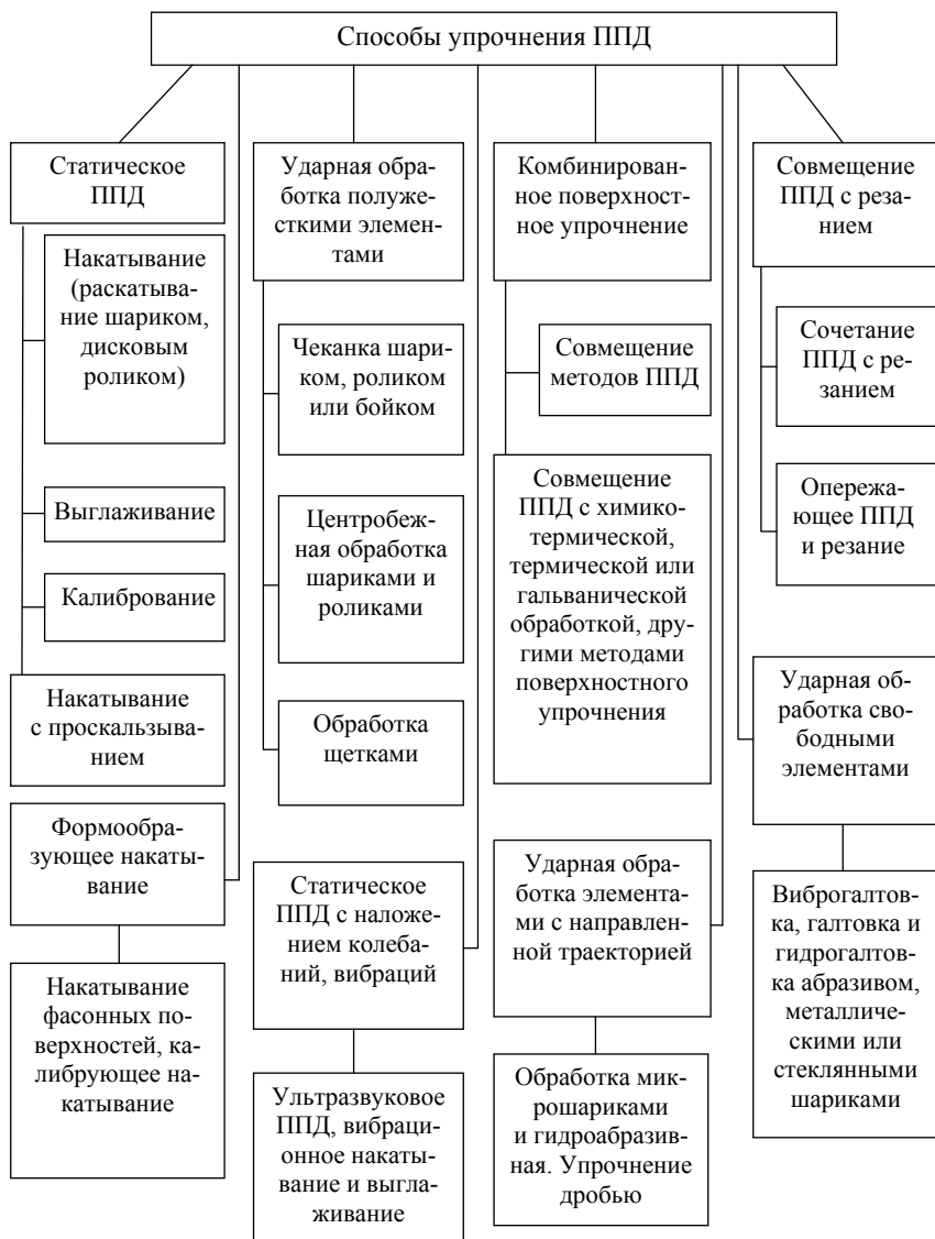
Рис. 1. Классификация способов поверхностного пластического деформирования
