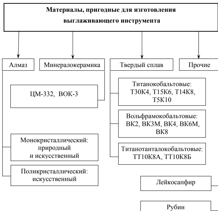
Рис. 17. Материалы, используемые при изготовлении шлифователей
