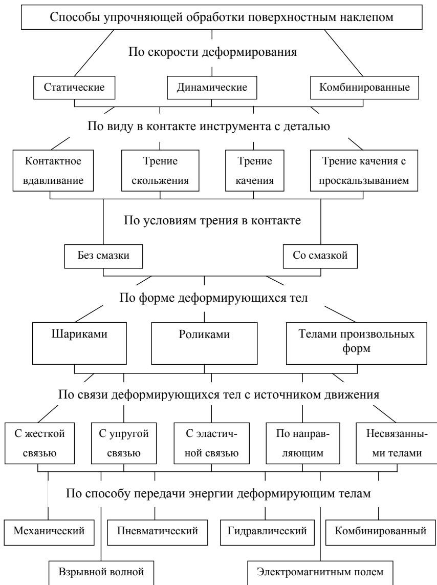
Рис. 2. Классификация способов упрочняющей обработки поверхностей деталей
