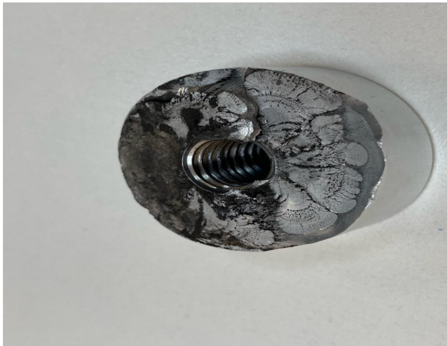
Рисунок 21 – Общий вид излома волновода 1 справа
