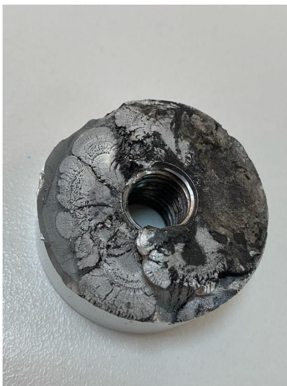
Рисунок 14 – Образец после испытаний на разрыв
