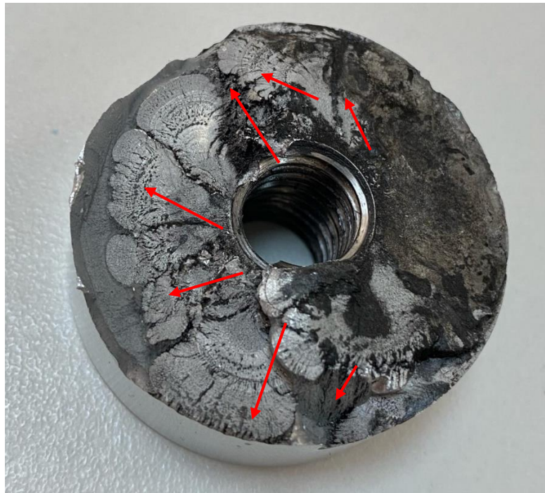
Рисунок 20 – Общий вид излома волновода 1 слева. Красными стрелками показаны направление распространения усталостной трещины в некоторых фрагментах усталостного разрушения
