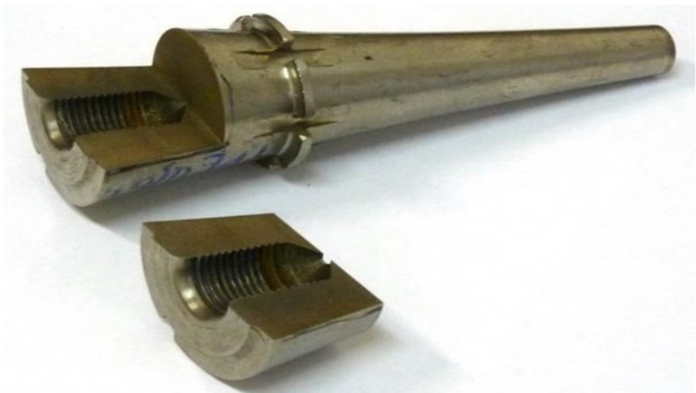
Рисунок 11 – Волновод после механической обработки
