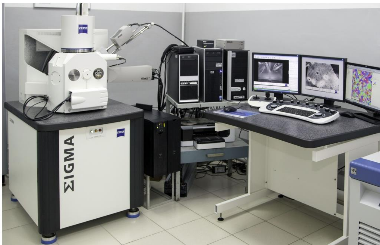
Рисунок 6 - Сканирующий электронный микроскоп Zeiss Sigma [31]
